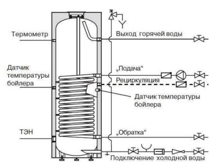
3. Схема подключения бойлера в составе котельной для нагрева воды для хозяйственных и бытовых нужд.
